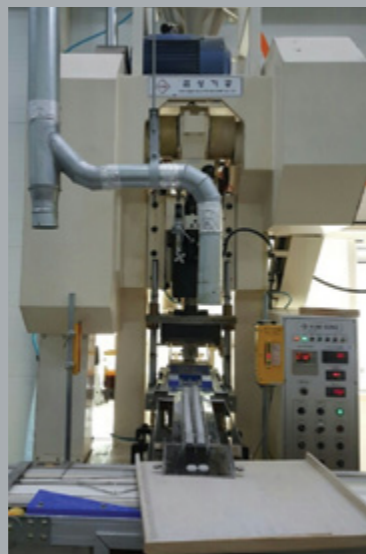
Формовочный пресс для прессования порошка
